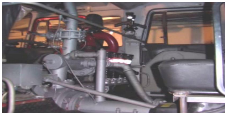
Рис. 1. Расположение пожарного насоса в кабине личного состава [2]
