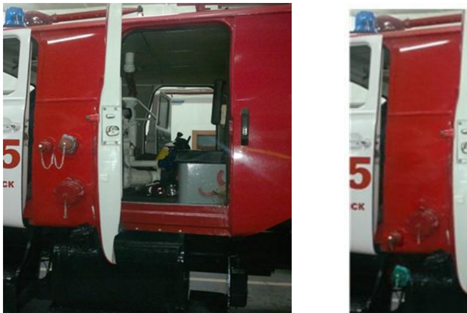
Рис. 3. Расположение патрубков водопенных коммуникаций в стандартном исполнении (слева) и в модернизированном варианте
